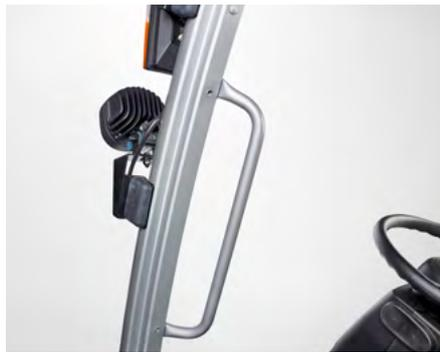
Eine niedrige Einstiegshöhe, ein großer Griff als Einstiegshilfe und der großzügige Fußraum sorgen für bequemen Zugang zur Fahrerzelle. An Bord des M300 steht eine Reihe von mechanischen oder elektronischen Steuerelementen zur Auswahl, wogegen der M300H entweder über Minihebel oder Mini-Joysticks bedient wird.
