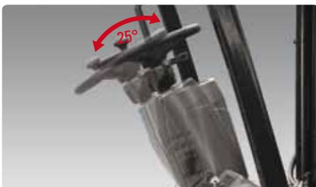
**Einstellbares Lenkrad mit Drehknopf**
