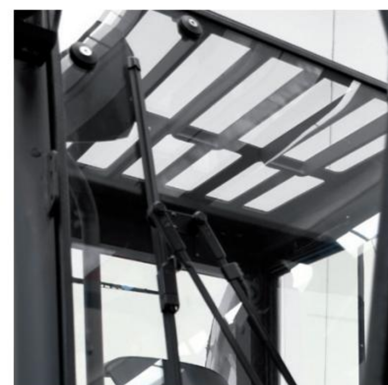
Windschutzscheibe und Dach mit Wisch-/Waschanlage
