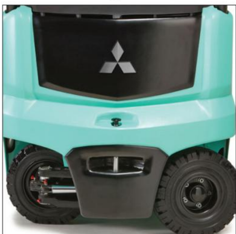
Hinterachse lenkt um mehr als 100 Grad ein
