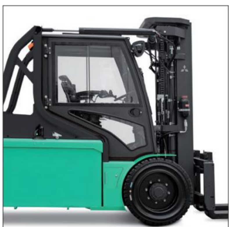
Niedriges Lastschutzgitter für Arbeiten in Containern
