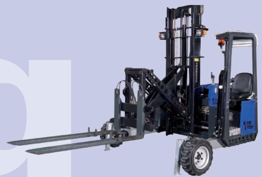
Das 4-Wegesystem transformiert den Mitnahmegabelstapler zu einem fortschrittlichen Seitenlader.
