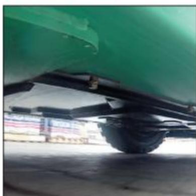
Rahmen mit Unterboden-Schutzplatte
