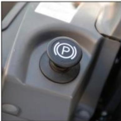
Elektronisch kontrollierte Feststellbremse
