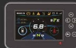
Grafische Benutzeroberfläche / Chinesische Störungsanzeige / integrierte Handheld-Funktion/ optionale integrierte Fahrzeugvernetzungsfunktion
