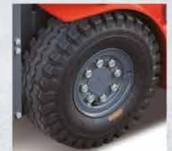
Elektrischer Spezialreifen mit niedrigem Dämpfungsgrad beim Fahren
