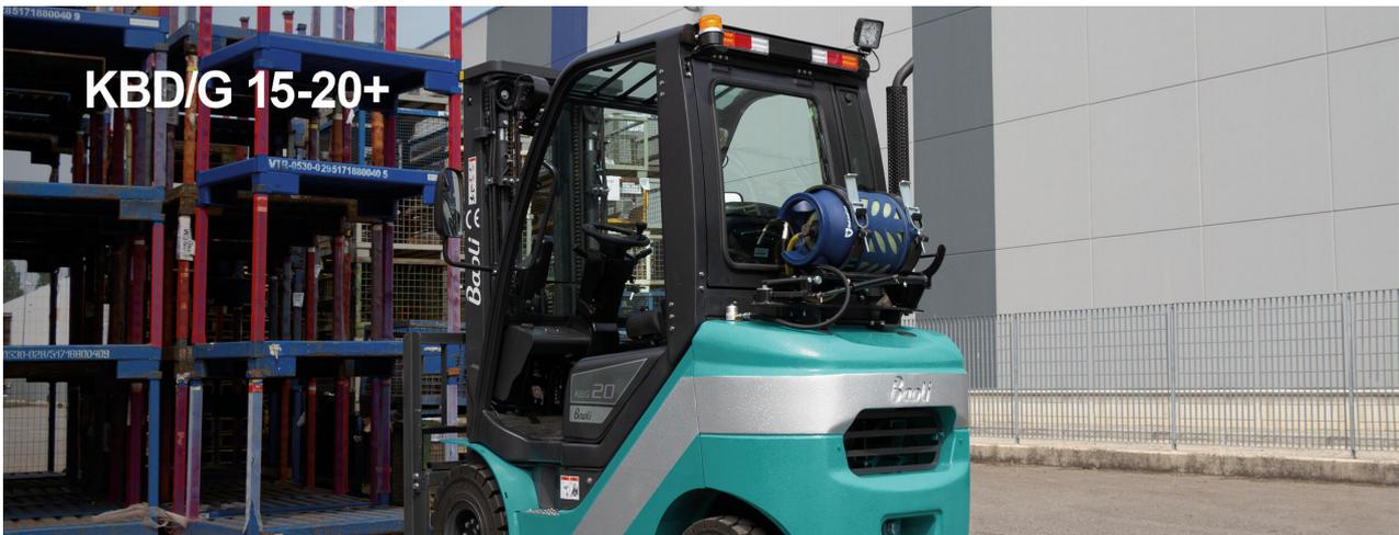
Die Gabelstapler KBD/G 15-20+ sind erhältlich mit einer Tragfähigkeit von 1,5, 1,8 oder 2,0 t. Die einfache und robuste Bauweise ist für Produktivität und herausragende Stabilität ausgelegt.
