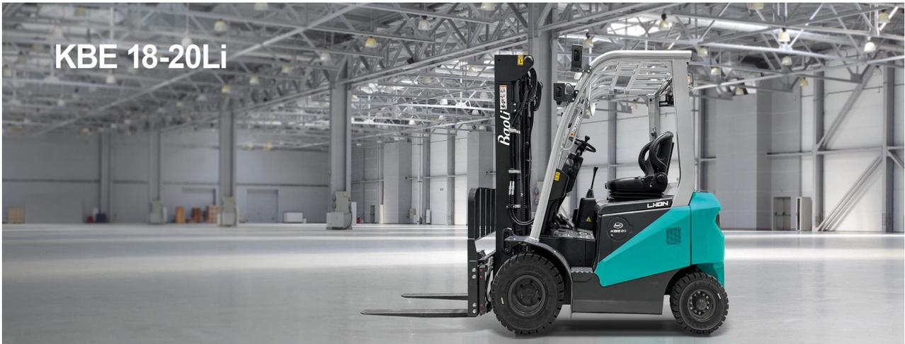
Die KBE 18Li und KBE 20Li mit einer Tragfähigkeit von 1,8 bis 2,0 Tonnen und einer maximalen Hubhöhe von 6,5 Metern sind dank ihrer Emissionsfreiheit und ihres geringen Geräuschpegels ideal für Logistik und Industrie, insbesondere in Innenräumen. Diese Stapler eignen sich besonders für leichte bis mittelschwere Einsätze und zeichnen sich durch ein kompaktes Design für eine einfache Handhabung auf engstem Raum aus.
