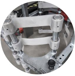
Sonder-entwickelte Greifer aus Polyurethan
