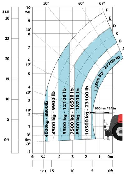
Maschine auf Rädern mit Gabelzinken LC 1200 mm
