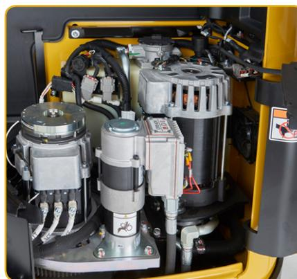
Eine abnehmbare Platte ermöglicht den Wartungszugriff auf das Antriebsrad/Untersetzungsgetriebe. Der Motorraum, darin auch der Hubmotor, ist belüftet.
