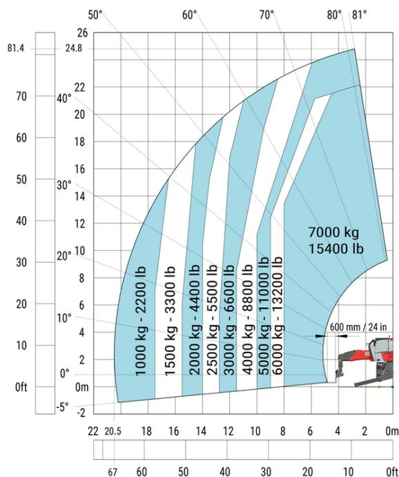
Drehung an abgesenkten Stützen mit 1500 kg Ausleger
