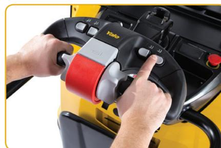
und gestattet dadurch das Fahren auf unebenem Boden, Ladeebenen und Rampen. Die Hub-/Senksteuerung erfolgt über zwei Drucktasten links an der Deichsel. Die einstellbaren Zugstangen ermöglichen eine gleichförmige Hub- und Senkbewegung der Gabelzinken. Die Lastrollen in Tandemausführung sind mit Schmierpunkten und gekapselten Lagern ausgestattet. Bei angehobenen Lastarmen wird die Geschwindigkeit automatisch reduziert.
