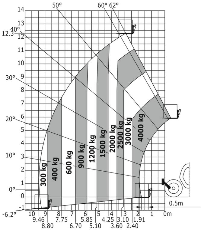
Maschine auf Stützen mit Gabelzinken
