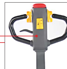
Multifunktionelle, ergonomische Steuerung mit stufenloser Geschwindigkeitseinstellung
