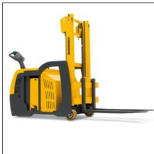
Erhöhte Bodenfreiheit durch große Lasträder.
