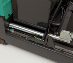
Batterie auf Rollen
