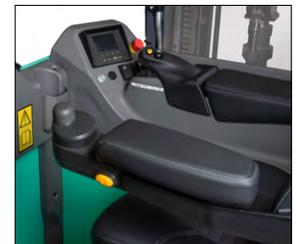
Mini-Lenkrad mit schwimmend gelagerter Armlehne
