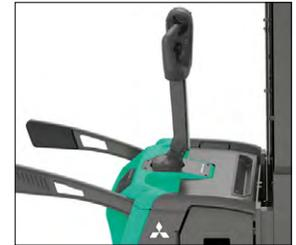
Deichselarm aus Metall mit mechanischer Lenkung
