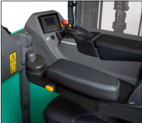
Mini-Lenkrad mit schwimmend gelagerter Armlehne
