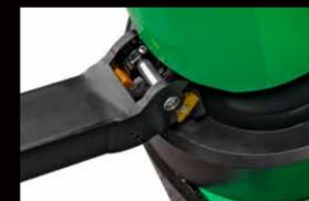
Deichselstapler mit neuem Antriebskonzept und geänderten Aufbau, so dass keine Kabel gedehnt oder gebogen werden.
