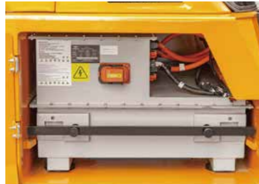
Lithiumbatterie mit besonders hoher Kapazität
