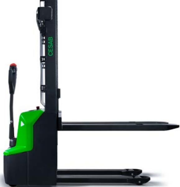
Der **CESAB S010i** hat eine Vierradkonstruktion und bietet höchste Stabilität – Hubhöhen bis zu 3,6 m
