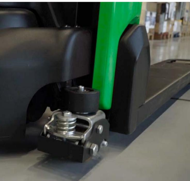
**P013i:** sowohl das Antriebsrad als auch die Stützräder verfügen serienmäßig über einen sicheren Fußschutz
