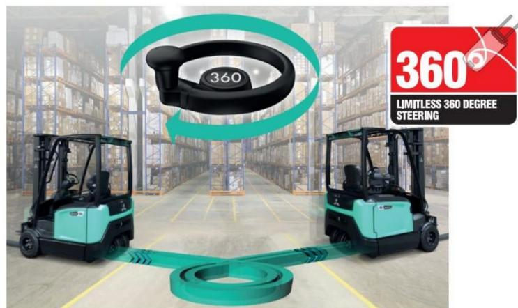
**EDiA EM'S** 360-Grad-Lenkung macht herkömmliche Drei-Punkt-Wendungen überflüssig. Die gleichmäßige Wendung ohne zu stoppen, reduziert die Zentrifugalkraft erheblich und sorgt so für schnelle und sichere Arbeitsabläufe.
