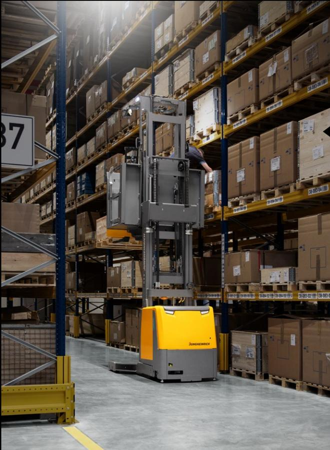
Das übergangsfreie Dreifach-Teleskop-Hubgerüst vermeidet Stoßbelastungen für den Fahrer.
