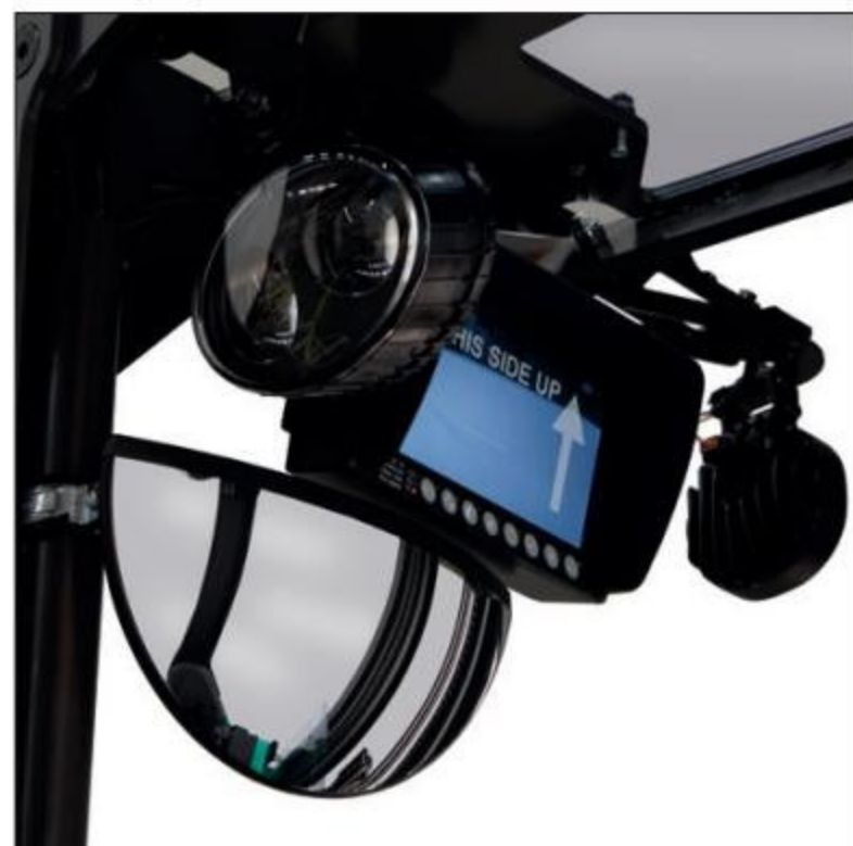
Mastoon asennettu videokameramonitori
