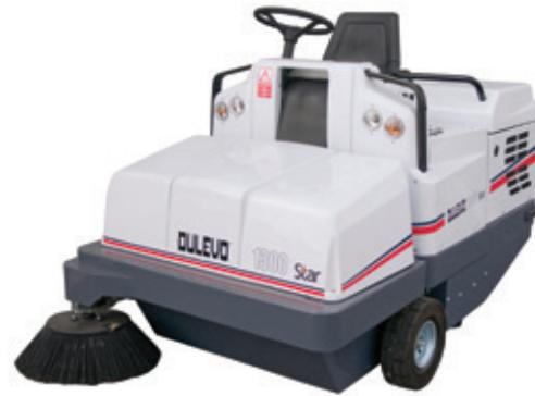
Die DULEVO Star 1300 ist eine selbstfahrende Industrie-Kehrsaugmaschine für den leichten bis mittelschweren Einsatz.
