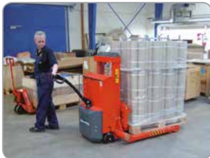
Optimale Sicherheit: u.a. schlagfeste Schutzscheibe und herabgesetzte Fahrgeschwindigkeit in gehobener Stellung.
