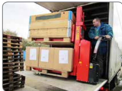
Niedriges Eigengewicht bedeutet bessere Ausnutzung der Tragfähigkeit einer LKW Hebebühne.
