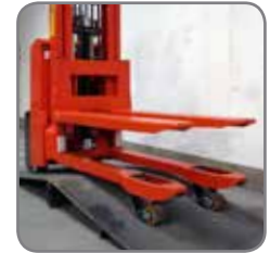
Der grosse Bodenabstand vereinfacht das Manövrieren auf unebenen Böden
