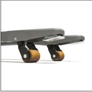
Initialhub für mehr Bodenfreiheit und 2,0 t Tragfähigkeit
