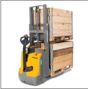
Doppelstockeinsatz: Aufnahme von zwei Paletten übereinander
