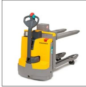
Kurzer Hubmast des EMD 115i für ergonomisches Kommissionieren bis zu einer Höhe von 690 mm
