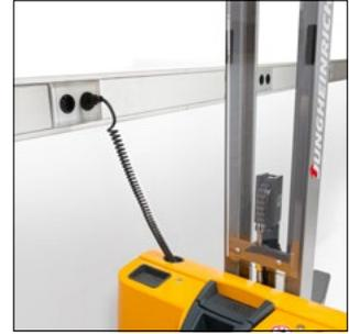
Einfaches Laden an jeder 230-V-Netzsteckdose dank integriertem Ladegerät
