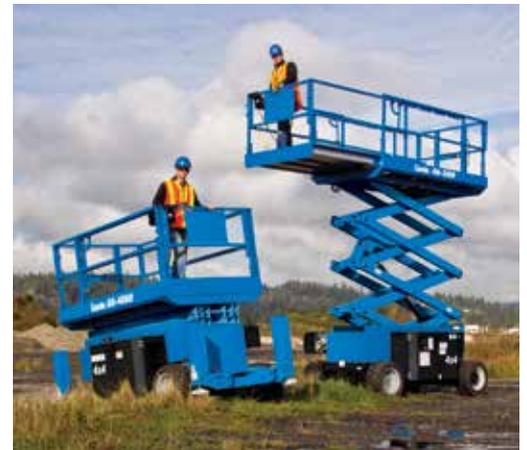
Die GS-69 RT-Modelle verfügen über einen Plattformausschub, der zwischen 91 cm und 1,52 m ausgefahren werden kann.
