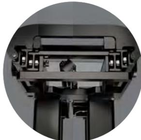
Ineinander versetzte Doppel-T-Profile und massive Stahlquerstreben kennzeichnen die Bauweise der robusten, hochstabilen Masten mit hohen Resttragfähigkeiten.
