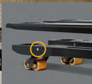
Der Initialhub von Crown basiert auf einem Zugangensystem, bei dem die Achsaufhängung am höchstmöglichen Punkt positioniert ist, um Schäden und Verschleiß vorzubeugen.
