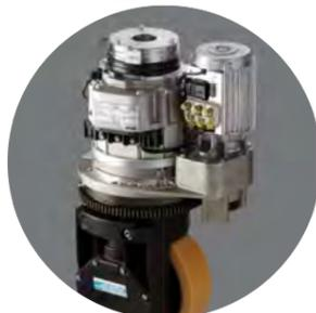
Crowns AC-Fahrmotor und das Getriebe mit gusseisernem Gehäuse sind für schwerste Lasten ausgelegt. Das e-GEN® Bremssystem nutzt das Drehmoment des Motors zur Bremsung ohne Scheibenbremsen und funktioniert auch an Gefällen schnell und zuverlässig. Alle Modelle sind optional mit elektronischer Lenkung lieferbar.
