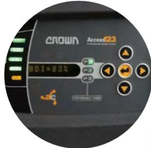
Zu Crowns Access 1 2 3° Steuerung gehören ein sicherer Zugang mittels PIN-Abfrage, Informationen über den Fahrzeugstatus und eine integrierte ausführliche Diagnosefunktion für schnellere Wartung und längere Betriebsbereitschaft.
