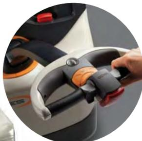
Das gusseiserne Drehgelenk der Deichsel, der geformte Stahlarm und der Deichselgriff aus Aluguss halten stärkste Belastungen aus. Im Sonderfahrbereich der X10° Deichsel lässt sich der Stapler selbst bei nahezu vertikaler Deichselstellung zentimetergenau manövrieren.
