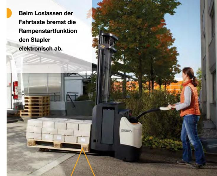
Der Initialhub bietet mehr als 100 Millimeter zusätzliche Bodenfreiheit – ein entscheidender Vorteil bei der Beladung von Lkw und beim Befahren von Rampen.
