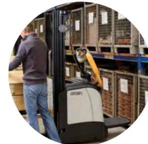
Die QuickExit-Seitenbügel lassen sich leicht hochklappen, so dass die Bediener auch in engen Bereichen seitlich schnell aussteigen können. Fahrzeuge mit mechanischer Lenkung stoppen den Hubvorgang automatisch bei 1,8 Metern, wenn die Seitenbügel nicht vollständig heruntergeklappt sind.
