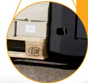
Mit optionalen Ein- und Ausfahrrollen können die Initialhubmodelle selbst leere Paletten über die Bodenbretter quer aufnehmen.
