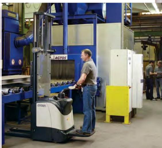
Mit dem schmalen Chassis und der mittig platzierten Deichsel kommt es zu weniger Warenschäden. Zudem ist der Stapler bei der Blocklagerung wendiger.
