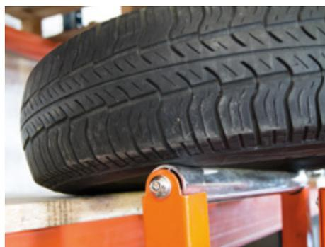
**OPTIONAL:** Möglichkeit, die Maschine mit einem Arm mit Hubseilen zu gerüsten, um die Reifen auf der Fläche zu lagern. Das hilft den Reifen vom Tool in das Regal zu bewegen, ohne ihn anheben zu müssen. Der Bediener unternimmt sodass keine Anstrengung und immer die richtige Position einnimmt.
