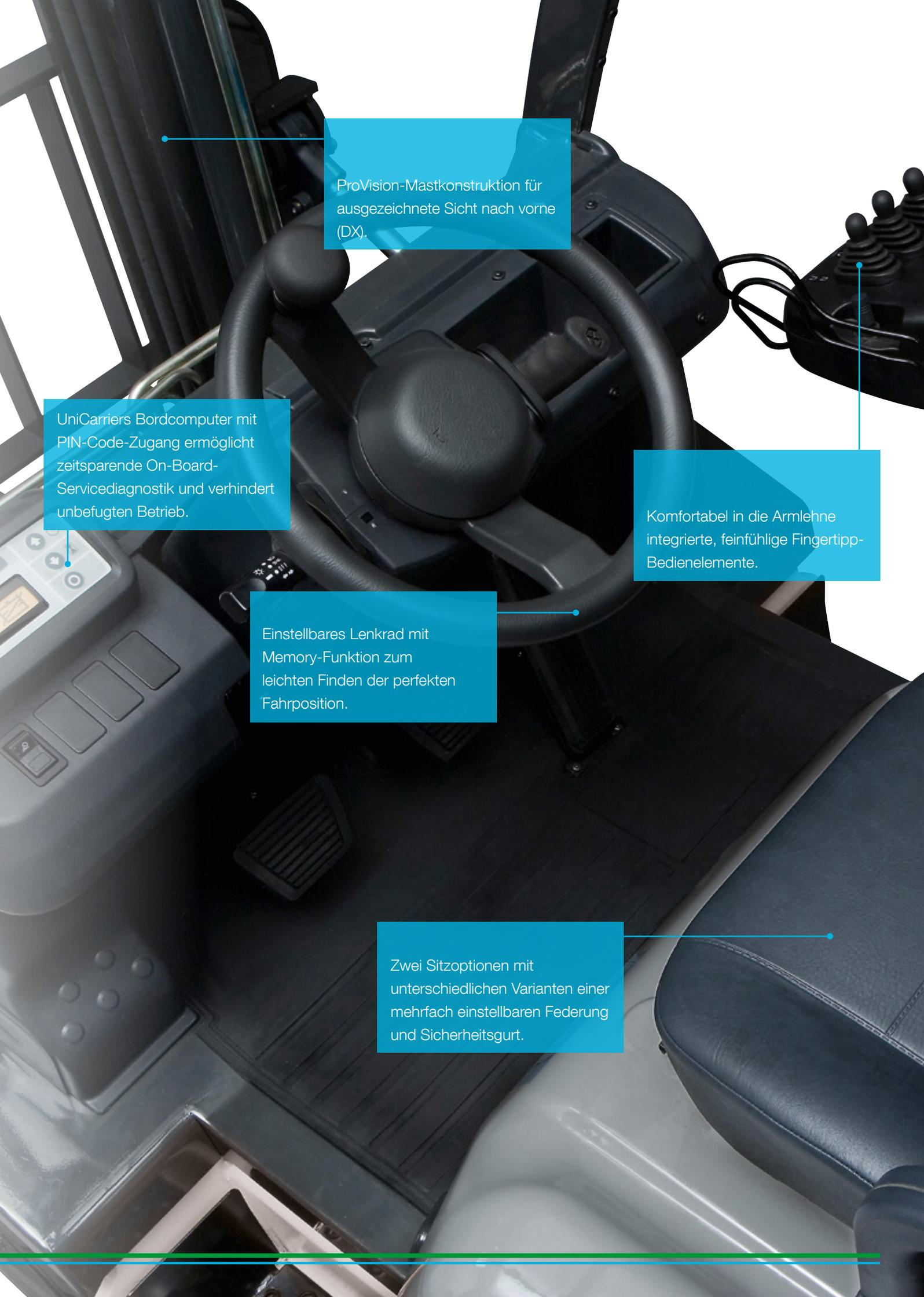
ProVision-Mastkonstruktion für ausgezeichnete Sicht nach vorne (DX).
