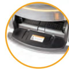
3. Handsensoren stellen sicher, dass der Bediener bei normalen Fahr- und Hubvorgängen beide Hände an den Bedienelementen hat. Zum Stabilisieren oder Halten einer Last kann bei Bedarf eine Hand von den Bedienelementen genommen werden.
