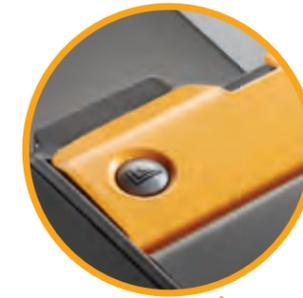
**Die Hubtaste** auf der Antriebseinheit ist für den Bediener beim Arbeiten neben der Ladung gut erreichbar.
