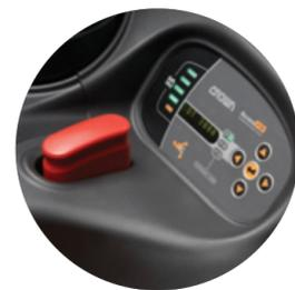
Die umfassende **Access 1 2 3<sup>®</sup> Systemsteuerung** bietet programmierbare Leistungsparameter, um den Stapler an Bedieneranforderungen oder die jeweiligen Einsatzbedingungen anzupassen.
