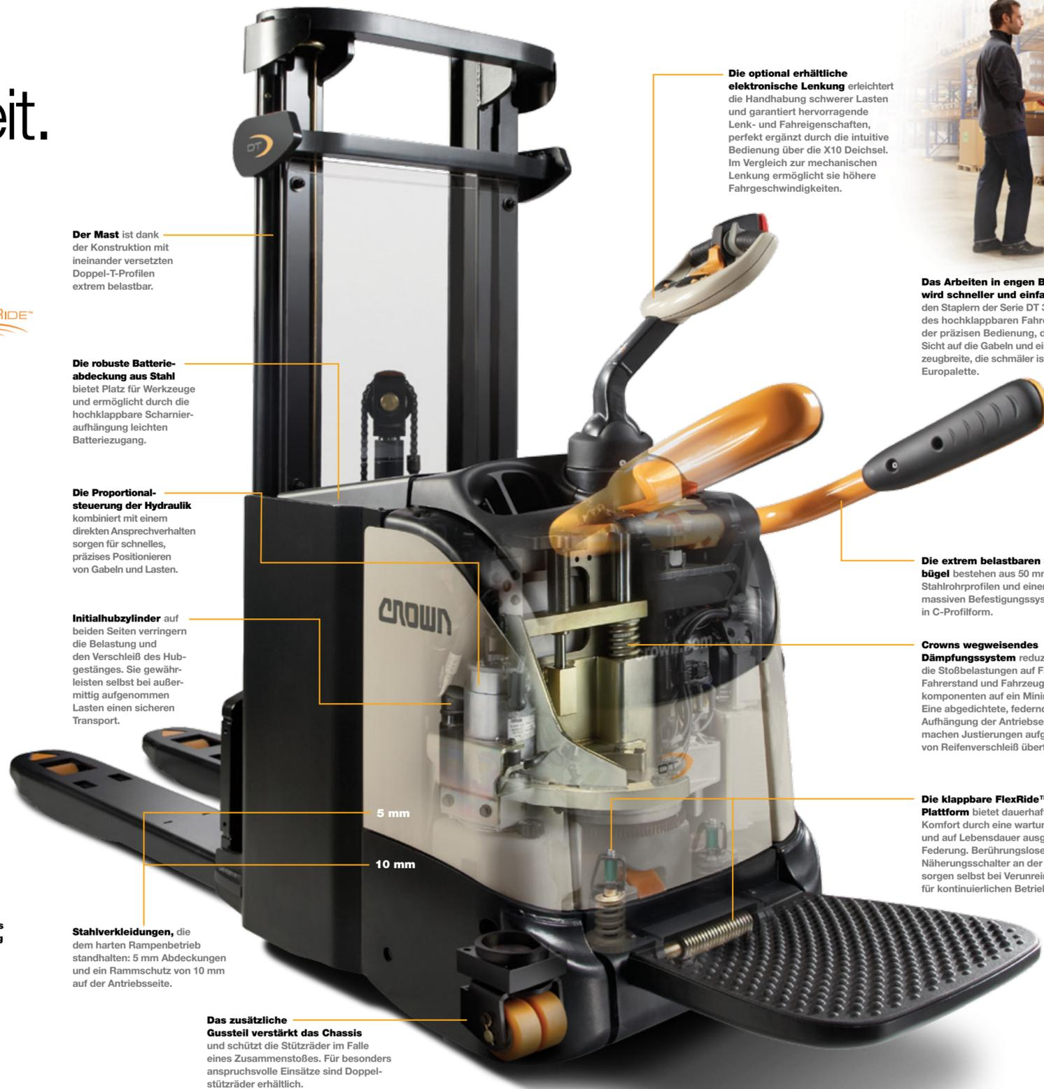
Die optional erhältliche **elektronische Lenkung** erleichtert die Handhabung schwerer Lasten und garantiert hervorragende Lenk- und Fahreigenschaften, perfekt ergänzt durch die intuitive Bedienung über die X10 Deichsel. Im Vergleich zur mechanischen Lenkung ermöglicht sie höhere Fahrgeschwindigkeiten.
