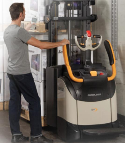
**Die Seitenbügel mit Schnellausstieg von Crown (Patent beantragt)** lassen sich hochklappen, so dass der Bediener das Fahrzeug seitlich verlassen kann und dadurch Zeit spart.
