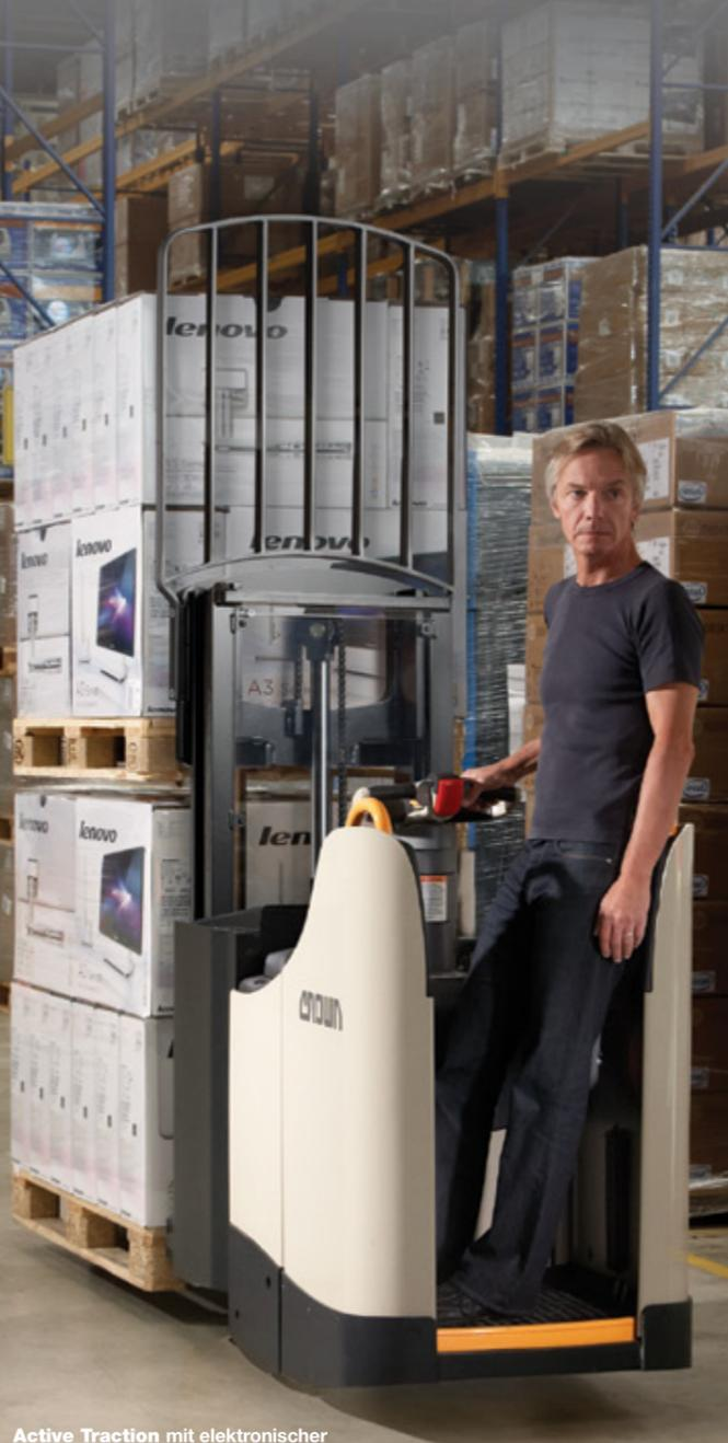
**Active Traction** mit elektronischer Lenkung zeichnet sich durch eine innovative Elektronik und Hydraulik aus, die den Druck auf das Antriebsrad je nach Lastverteilung, Geschwindigkeit, Beschleunigung und Abbremsung regelt.
