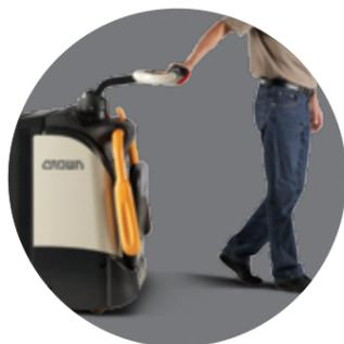
**Vorteile beim Manövrieren** bieten der hochklappbare Fahrerstand, die abgerundete Kontur der Antriebseinheit, die ergonomische Deichselposition und die hervorragende Fußfreiheit des Fahrzeugs.
