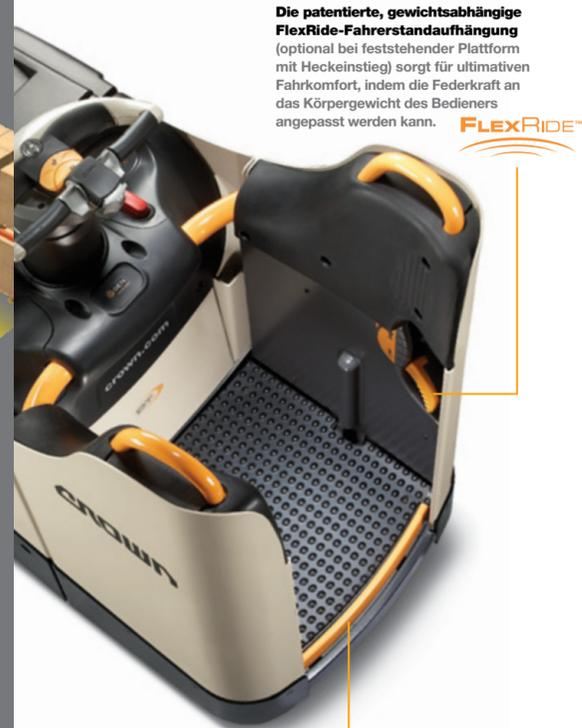
Die patentierte, gewichtsabhängige **FlexRide-Fahrerstandaufhängung** (optional bei feststehender Plattform mit HeckEinstieg) sorgt für ultimativen Fahrkomfort, indem die Federkraft an das Körpergewicht des Bedieners angepasst werden kann. **FLEXRIDE<sup>®</sup>**
