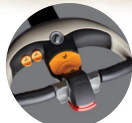
Die **X10<sup>®</sup> Deichsel aus Aluminiumdruckguss** ist ein weiteres Merkmal der robusten Bauweise und ermöglicht dank der proportionalen Hub- und Senkgeschwindigkeiten ein sanftes und präzises Positionieren der Paletten.
