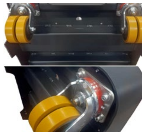
E5RD Doppelräder ideal für Schienen und zur Optimierung des Fahrens auf nicht ganz ebenen Böden.
