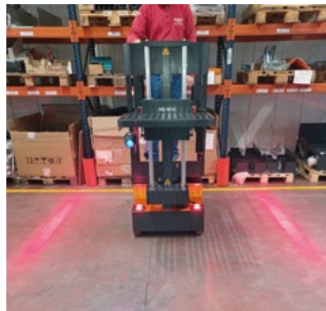
REDLIGHT1 2 x rote Seitensignalleuchten.
