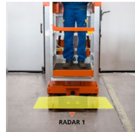
RADAR1 Vorderes Antikollisions Radar für den Chassis.
