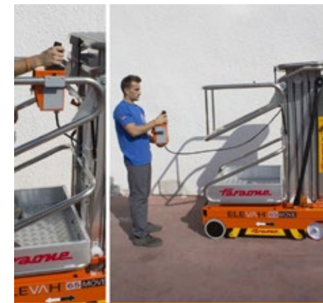
CA Abnehmbare Steuerung mit zusätzlichen 150cm Kabel.
