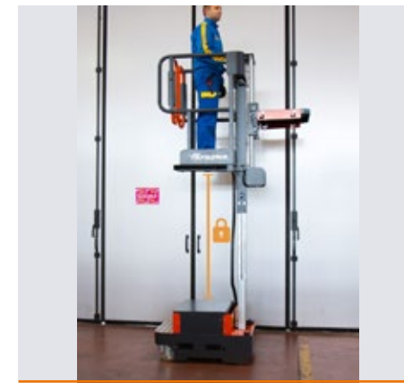
KEY ACC Schlüsselschalter zur Begrenzung der Standhöhe.
