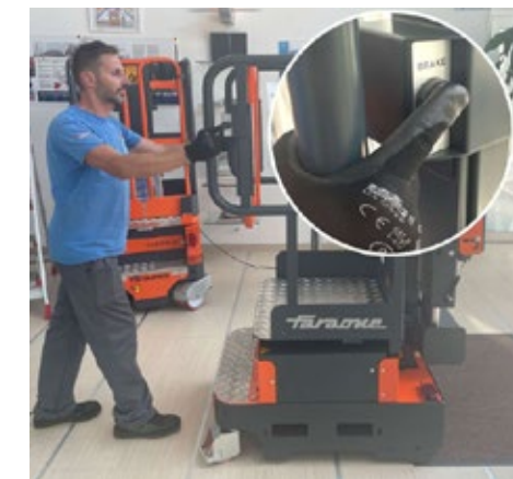
E5MAN Manuelles Lösen der automatischen elektronischen Feststellbremse. Ermöglicht das manuelle Bewegen der selbstfahrenden Maschine.
