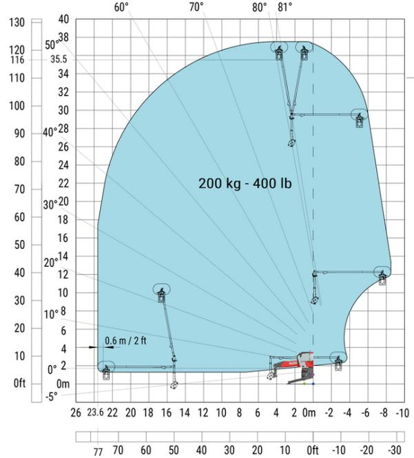
Drehung mit abgesenkten Stützen mit 3D negativ
