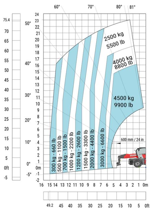
Drehung mit abgesenkten Stützen mit Gabeln
