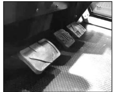
Optionen Fahrtrichtungswahl: Hebel an der Lenksäule, Wippschalter an der Armlehne, Doppelpedal
