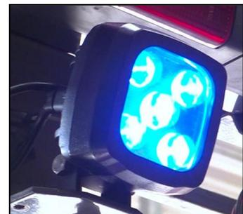
Optionen Beleuchtung: StVZO-Beleuchtung Hebel, Blitzlicht mit akustischem Rückfahrwarner, LED-Arbeitscheinwerfer, LED-Hubgerüstscheinwerfer. Bluelight-Sicherheitslicht
