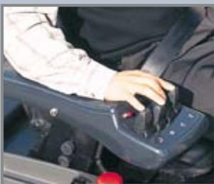
Finger- Tip Hydrauliksteuerventil
