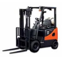
D15S / D18S-5 & D20SC-5 G15S / G18S-5 & G20SC-5 1.500kg / 1.750kg / 2.000kg Diesel und Treibgas
