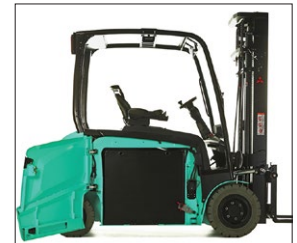
Chassis für seitlichen Batteriewechsel
