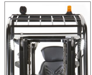
LED-Arbeitsscheinwerfer (2 an der Vorderseite und 1 an der Rückseite)
