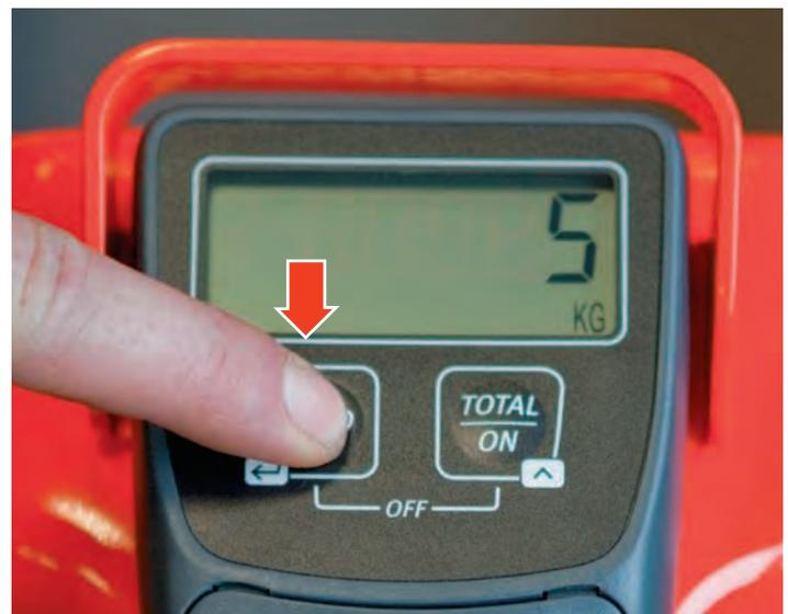
Bei einer Abweichung von +/- 5 kg, wird der Nullpunkt durch Drücken der ZERO-Taste korrigiert. Die Anzeige schaltet in den Wiegemodus.
