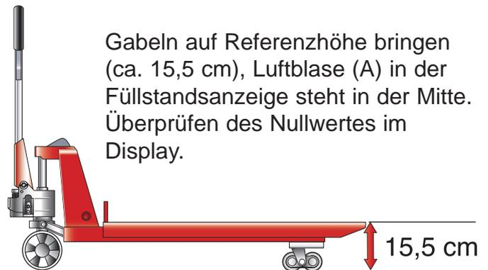
Gabeln auf Referenzhöhe bringen (ca. 15,5 cm), Luftblase (A) in der Füllstandsanzeige steht in der Mitte. Überprüfen des Nullwertes im Display.
