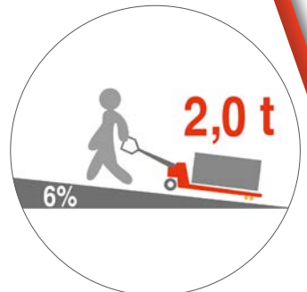
6% Steigfähigkeit bei Volllast
