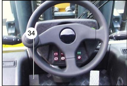
Bei der letzten Hälfte des Pedalweges wird das Getriebe ausgekuppelt und die Betriebsbremse aktiviert. Wird das Pedal weiter heruntergetreten, wird das Fahrzeug zum Halten gebracht. Die Bremskraft ist proportional zum Pedalweg.
