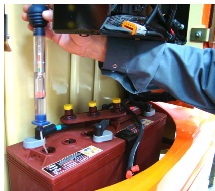
Bild 5-8. Messen des spezifischen Gewichts des Elektrolyts
