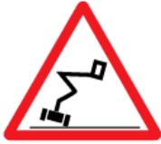
**MAX. Neigungswinkel überschritten:-** Der Alarm ertönt, dieses Bild wird angezeigt und Fahren wird deaktiviert. Ausleger in die Position Verstaut absenken und die Maschine auf ebenen Grund fahren, um vollständige Maschinenfunktion wieder herzustellen.
